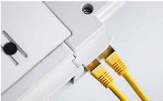
Das integrierte BUS-System mit RJ45-Anschluss gewährleistet verwechslungsfreie Verdrahtung und trennt Steuerleitungen räumlich ab.
