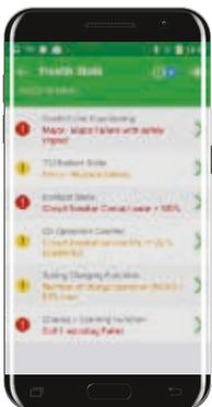
Das Steuer- und Auslösegerät Micrologic X ermöglicht einen hohen Grad an Diagnostik der Leistungsschalter Masterpact MTZ in Echtzeit. Es erzeugt und speichert entsprechende Warnungen, Alarme und Meldungen, die den Benutzer bei der Wartung und der Wiederherstellung der Stromversorgung unterstützen.
