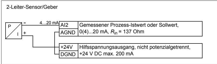
**Hinweis:** Der Sensor wird über seinen Stromausgang versorgt und der Frequenzumrichter stellt die Speisespannung (+24 V) bereit. Das Ausgangssignal muss 4...20 mA, nicht 0...20 mA betragen.
