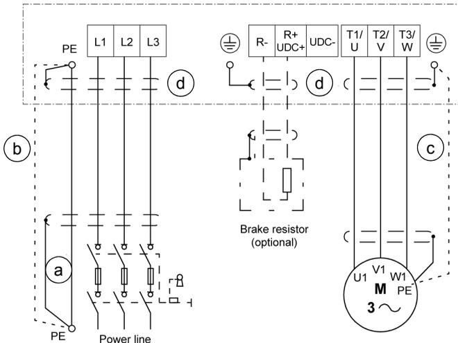
a. Zwei Erdungsleiter. Zwei Leiter verwenden, wenn der Querschnitt des Erdleiters weniger als  $10 \text{ mm}^2 \text{ Cu}$  oder  $16 \text{ mm}^2 \text{ Al}$  beträgt (IEC/EN 61800-5-1). Beispielsweise den Kabelschirm zusätzlich zum vierten Leiter verwenden.
