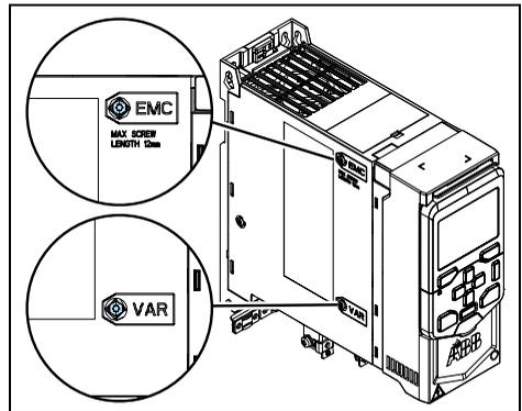
Die EMV-Erdung Schraube befindet sich bei den Baugrößen R3 und R4 unten.
