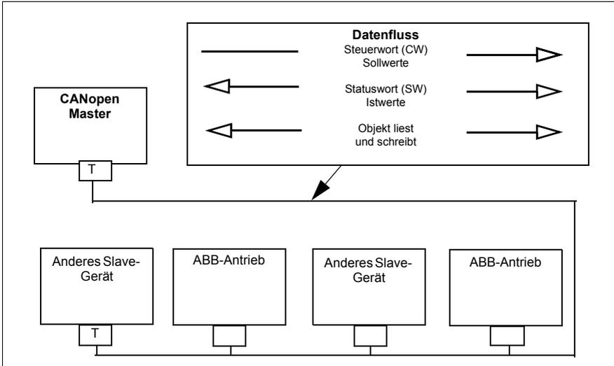
**Einrichtung der integrierten Feldbus-Schnittstelle (CANopen)**
