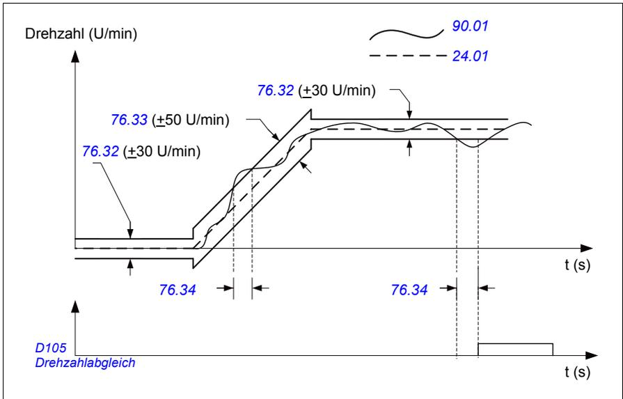
Das Diagramm zeigt die Funktion der Warnung **Bremsschlupf bei Stillstand2**.
