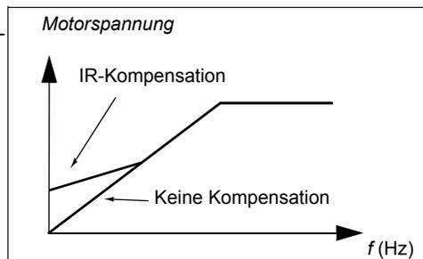
Bei der Vektorregelung ist keine IR-Kompensation möglich oder erforderlich, da es automatisch angewendet wird.
