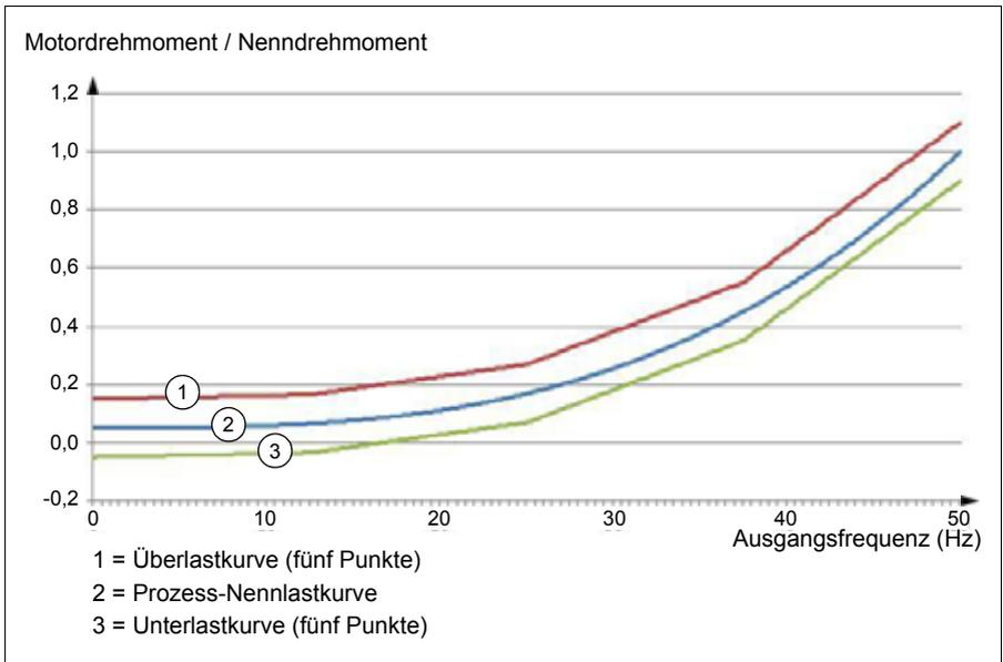
Eine Überlast-Warn- und/oder Störmeldung kann aktiviert werden, wenn das überwachte Signal dauerhaft für eine eingestellte Zeit über der Überlastkurve bleibt. Eine Unterlast-Warn- und/oder Störmeldung kann aktiviert werden, wenn das überwachte Signal dauerhaft für eine eingestellte Zeit unter der Unterlastkurve bleibt.
