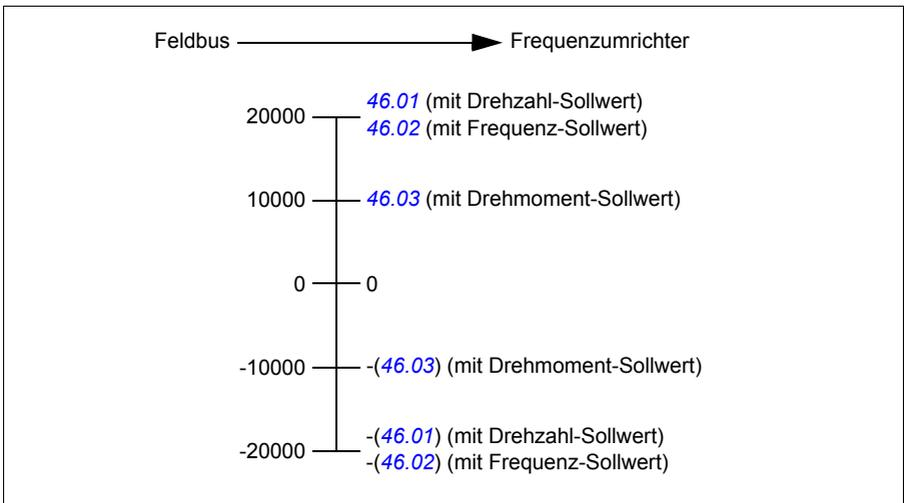
Die skalierten Sollwerte werden angezeigt mit den Parametern [03.05 Feldbus A Sollwert 1](#) und [03.06 Feldbus A Sollwert 2](#).
