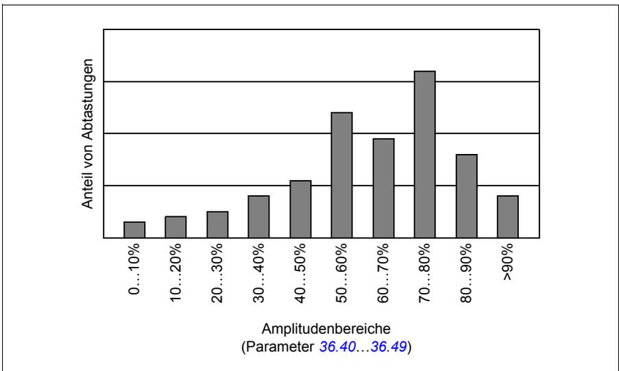
Der Amplituden-Speicher 1 ist fest auf die Überwachung des Motorstroms eingestellt und kann nicht zurückgesetzt werden. Beim Amplituden-Speicher 1 entsprechen 100% dem maximalen Ausgangsstrom des Frequenzumrichters ( $I_{max}$ ). Die Maximalwerte des Ausgangsstroms sind in Abschnitt *Nenn Daten* in the *Hardware manual* des Frequenzumrichters aufgelistet. Der gemessene Strom wird kontinuierlich gespeichert. Die Verteilung der Messpunkte wird mit Parameter [36.20...36.29](#) angezeigt.
