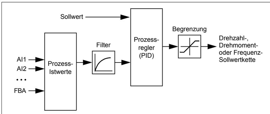
Im Frequenzumrichter können zwei komplette Sätze von Prozessregler-Einstellungen parametrisiert werden, zwischen denen bei Bedarf umgeschaltet werden kann; siehe Parameter [40.57 Ausw. P.reg1.Satz1/Satz2](#).
