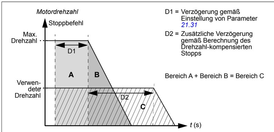
Die Drehzahlkompensation berücksichtigt nicht die Rampen-Verschleißzeiten (Parameter [23.32 Verschleißzeit 1](#) und [23.33 Verschleißzeit 2](#)). Positive Verschleißzeiten verlängern die zurückgelegte Strecke.
