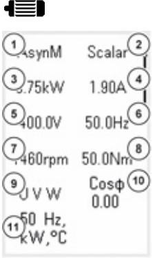
1. Motortyp - AsynM, PMSM, SynRM
