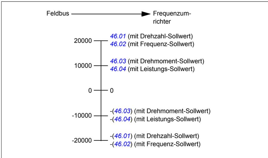
Die skalierten Sollwerte werden angezeigt mit den Parametern [03.09 Integr.Feldbus Sollw.1](#) und [03.10 Integr.Feldbus Sollw.2](#).
