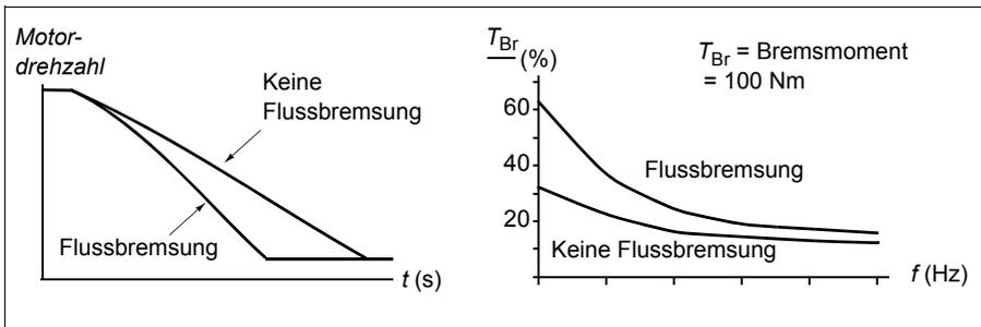
Der Frequenzumrichter überwacht ständig - auch während der Flussbremsung - den Status des Motors. Deshalb kann die Flussbremsung sowohl für das Bremsen des Motors als auch für die Änderung der Drehzahl verwendet werden. Weitere Vorteile der Flussbremsung sind:
