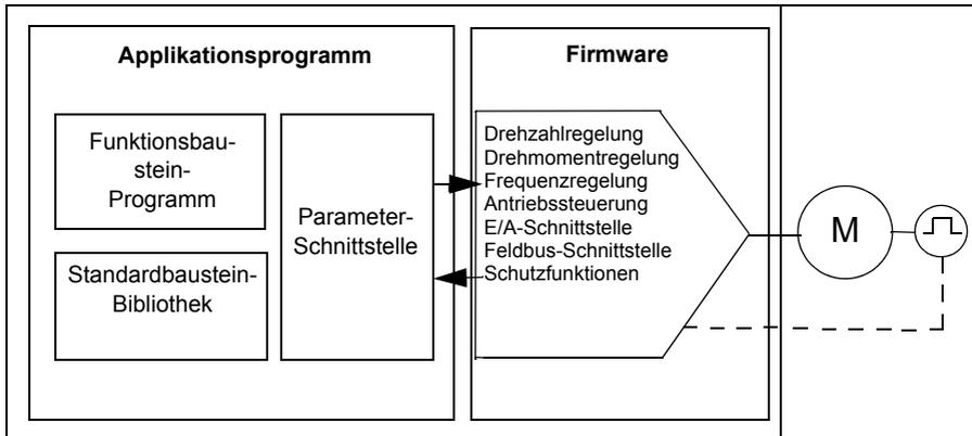
Mit der Firmware werden die Haupt-Regelungsfunktionen ausgeführt, einschließlich Drehzahl-, Drehmoment- und Frequenzregelung, Antriebssteuerung (Start/Stop), E/A, Signalerückführung, Kommunikation und Schutzfunktionen. Firmware-Funktionen werden mit Parametern konfiguriert und programmiert und können durch die Applikationsprogrammierung erweitert werden.
