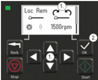
1. Im *Optionsmenü* mit den Pfeiltasten zum Menüpunkt für die Drehrichtung wechseln.
