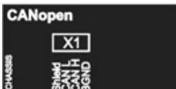
**Hinweis:** Bei Verwendung des CANopen-Moduls wird empfohlen, das Kabel beim erstmaligen Start nicht anzuschließen. Dadurch wird verhindert, dass der CAN-Bus gestört wird, wenn der Frequenzumrichter versucht, das angeschlossene Modul zu erkennen.
