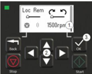
1. Im *Optionsmenü* zum Menüpunkt für den Drehmoment- oder Frequenzsollwert wechseln und „OK“ drücken.
