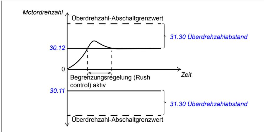
Die Funktion arbeitet mit einer PI-Regelung. Das Programm setzt die Proportionalverstärkung auf 10,0 und die Integrationszeit 2,0 s.
