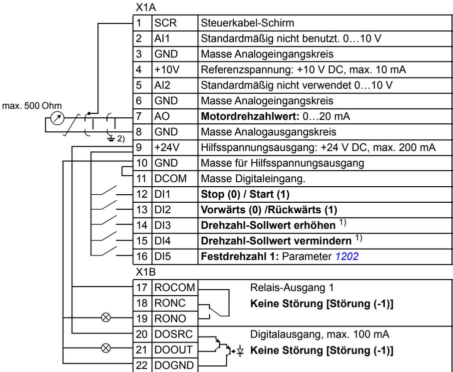
1) Sind sowohl DI3 als auch DI4 aktiviert oder deaktiviert, bleibt der Drehzahl-Sollwert unverändert. Der aktuelle Drehzahl-Sollwert wird beim Stop und beim Abschalten gespeichert.
