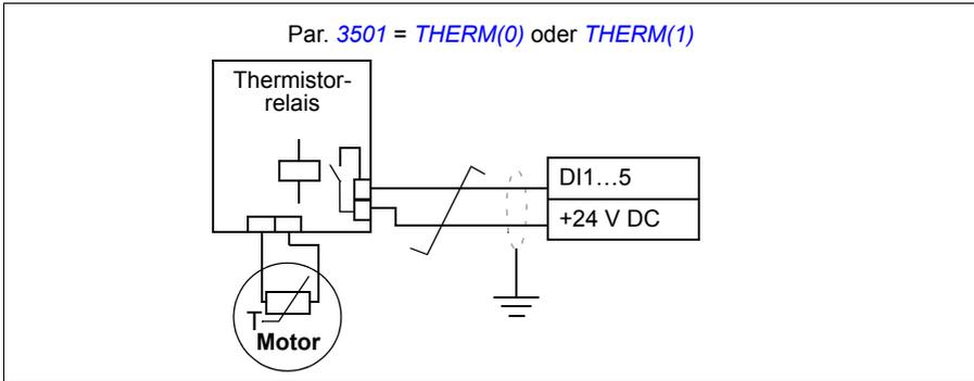
**⚠️ WARNUNG!** Gemäß IEC 60664 ist für den Anschluss des Motorthermistors an den Digitaleingang eine doppelte oder verstärkte Isolation zwischen den spannungsführenden Teilen des Motors und dem Thermistor erforderlich. Eine verstärkte Isolation beinhaltet eine Kriech- und Luftstrecke von 8 mm (0,3 in) (400/500 V AC-Ausrüstung).
