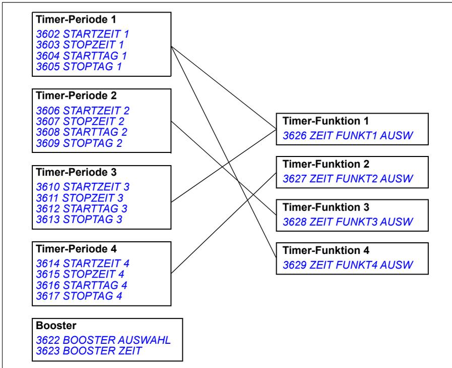
Ein Parameter, der von einer Timer-Funktion verwendet wird, kann jeweils immer nur an einen Timer angeschlossen werden.
