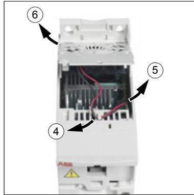
7. Den neuen Lüfterhalter mit Lüfter in umgekehrter Reihenfolge wieder montieren.
