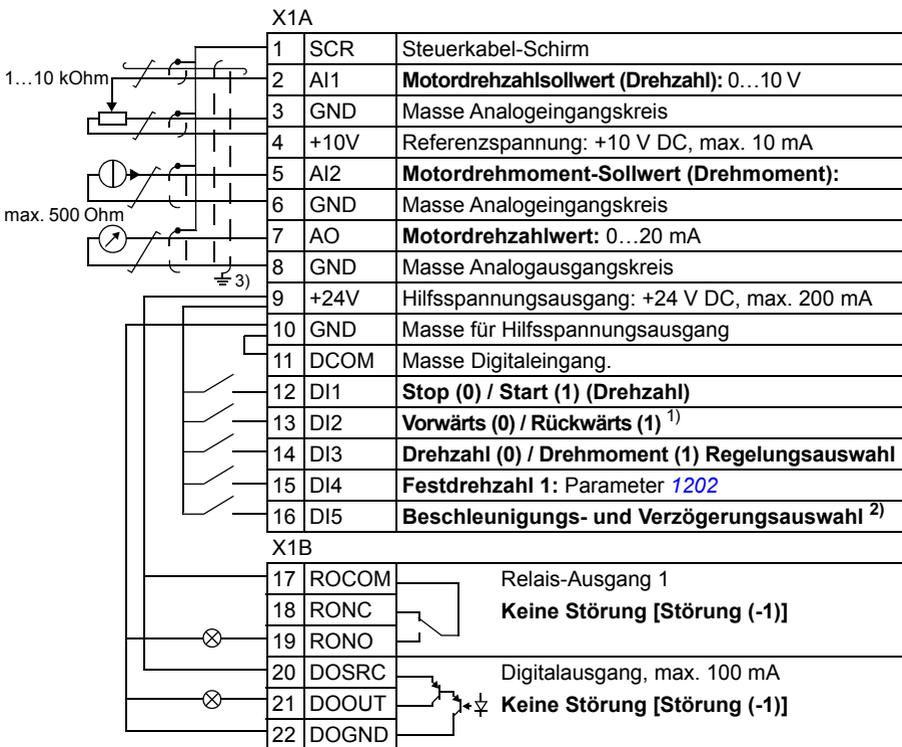
1) Drehzahlregelung: Wechselt die Drehrichtung.
