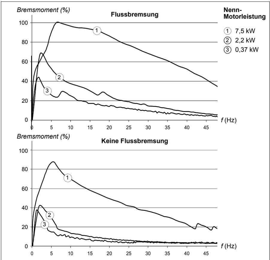
Der Frequenzrichter überwacht ständig - auch während der Flussbremsung - den Status des Motors. Deshalb kann die Flussbremsung sowohl für das Bremsen des Motors als auch für die Änderung der Drehzahl verwendet werden. Weitere Vorteile der Flussbremsung sind:
