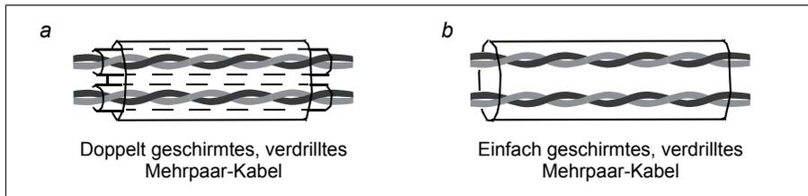
Analoge und digitale Signale müssen in separaten Kabeln übertragen werden.
