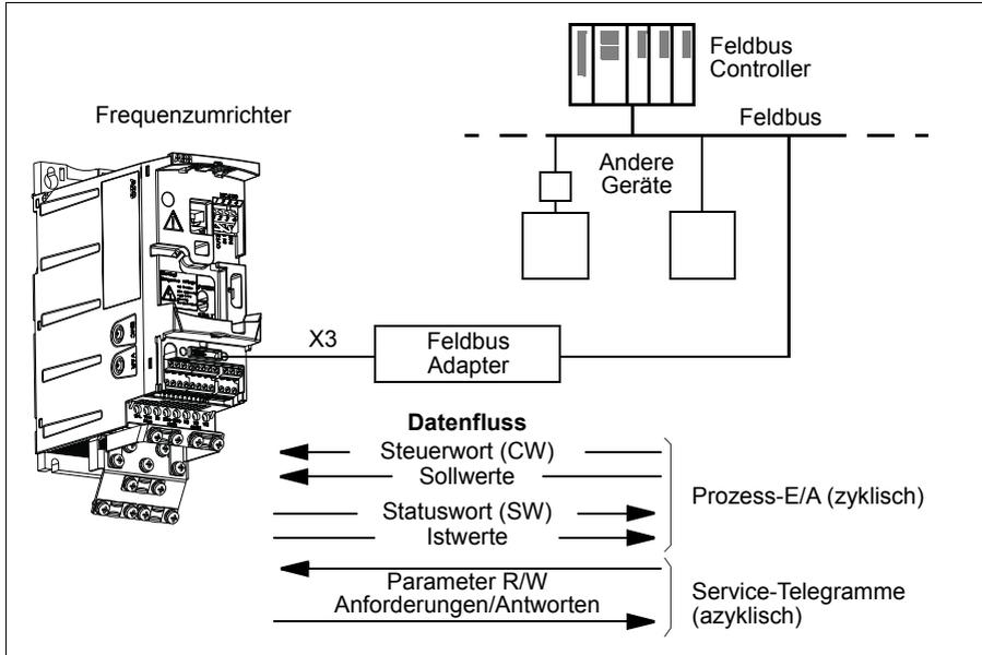
Der Frequenzumrichter kann so eingestellt werden, dass er alle Steuerinformationen über die Feldbus-Schnittstelle empfängt, oder die Steuerbefehle können auf die Feldbus-Schnittstelle und andere vorhandene Eingänge, wie Digital- und Analogeingänge, aufgeteilt werden.
