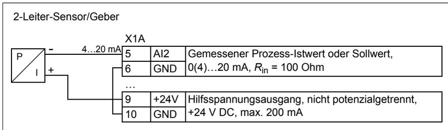
**Hinweis:** Der Sensor wird über seinen Stromausgang versorgt und der Frequenzumrichter stellt die Speisespannung (+24 V) bereit. Darum muss das Ausgangssignal im Bereich 4...20 mA liegen, nicht im Bereich 0...20 mA.
