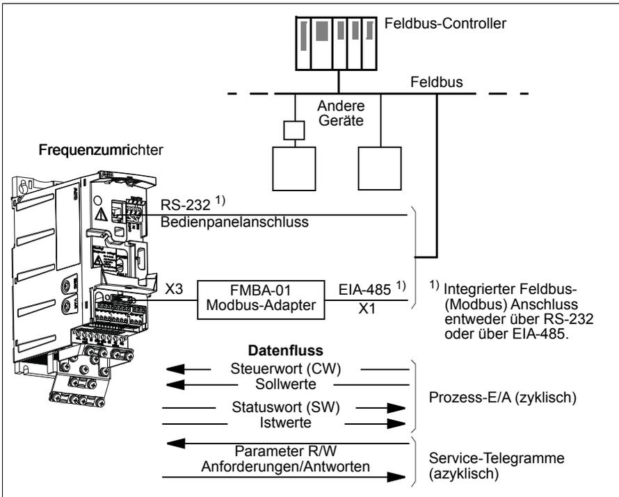
Der Frequenzumrichter kann so eingestellt werden, dass er alle Steuerungs-Informationen über die Feldbus-Schnittstelle empfängt, oder die Steuerung kann zwischen der Feldbus-Schnittstelle und anderen verfügbaren Quellen aufgeteilt werden, zum Beispiel Digital- und Analogeingänge.
