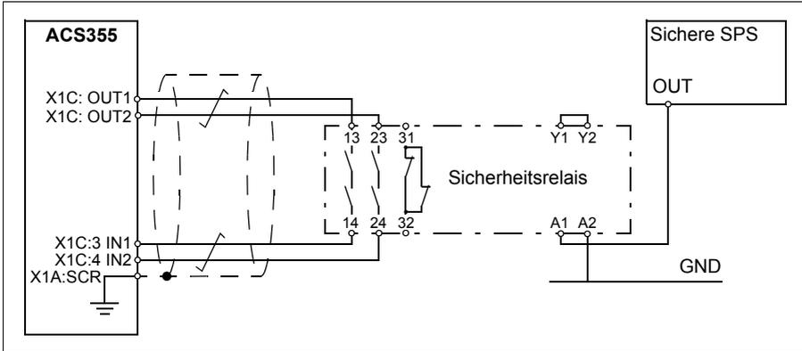
Ein Beispiel für die Verdrahtung der Funktion "Sicher abgeschaltetes Drehmoment" mit einer externen +24 V DC Stromversorgung ist unten abgebildet.
