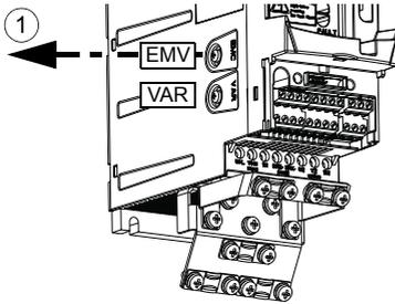
EMV-Schraube bei Baugröße R4, IP20
