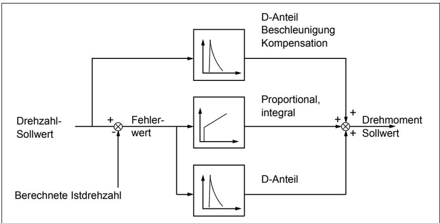
**Hinweis:** Der Drehzahlregler kann im Vektorregelungsmodus verwendet werden, d. h. wenn **9904 MOTOR REGELMODUS** auf **SVC: DREHZAHN** oder **SVC: DREHMOM** eingestellt ist.
