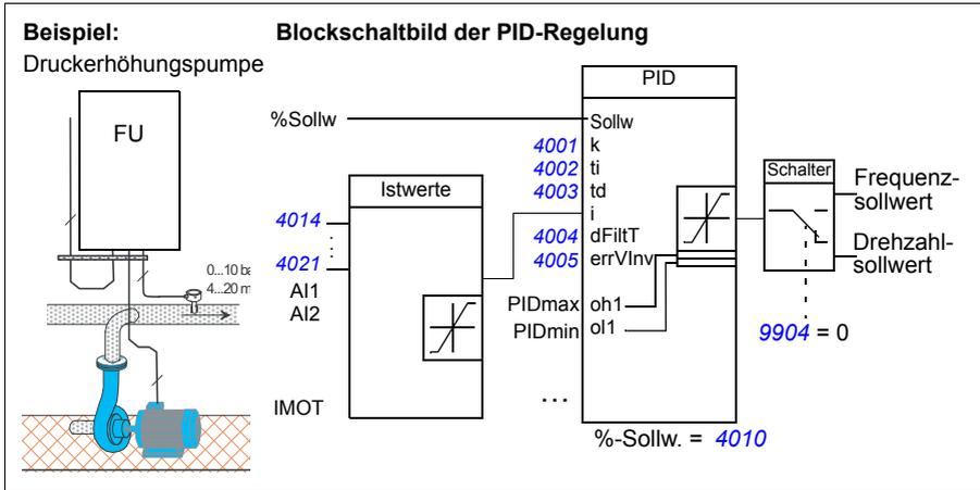
In der folgenden Abbildung wird das Blockschaltbild der Drehzahl-/Skalarregelung für Prozessregler PID1 dargestellt.
