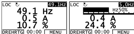
Wenn nur ein oder zwei Signale für die Anzeige gewählt werden, werden zusätzlich zum Wert oder zur Balkenanzeige die Nummer und der Name jedes angezeigten Signals eingeblendet. Anweisungen zur Auswahl und Bearbeitung der überwachten Signale siehe Seite [99](#).
