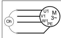
Feuchtigkeit innerhalb des Motorgehäuses reduziert den Isolationswiderstand. Bei Verdacht auf Feuchtigkeit den Motor trocknen und die Messung wiederholen.
