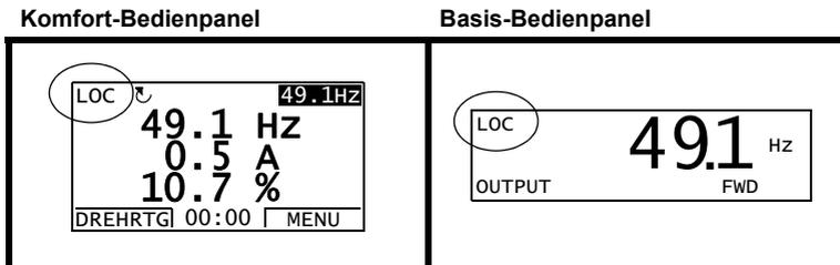
Das Bedienpanel hat bei Lokalsteuerung immer Vorrang vor externen Steuersignalquellen.
